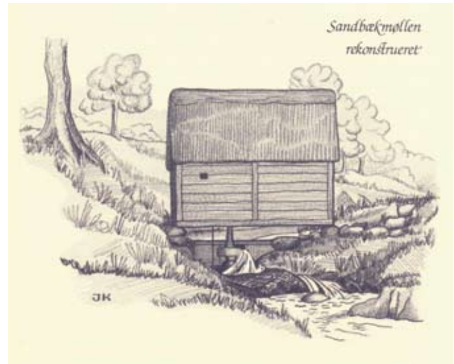
Fig. 4. Møllerne på den øverste del af åen var alle skvatmøller, dvs. små og afgiftsfrie private møller. I Sandbæk-møllen på Sydvestsjælland fra slutningen af 900-årene blev vandet stemmet op i en lav dam med overløb ved siden af møllen. Når møllen skulle køre, trak man et skod op, så vandet løb gennem et trug til skovlhjulet. Efter Axel Steensberg (1983): Borups bønder. Wormianum; s. 101.
